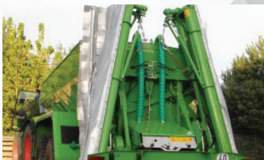
Внесение негашеной извести спомощью 9м или 12м шнека
