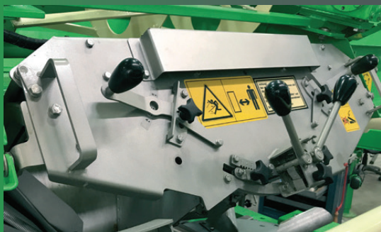
Приспособление для автоматического переключения секций(опция)
