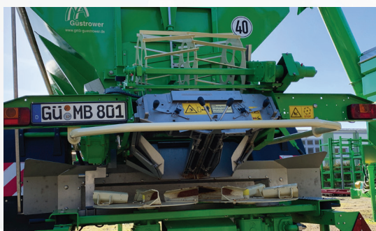
Диски расбрасывания с 4 регулируемыми лопатками для извести, сухого помёта и компоста
